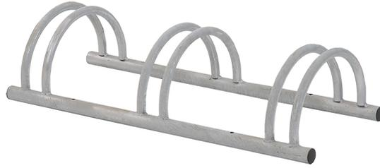
Struttura in acciaio zincato realizzata con tubi  $\varnothing$  mm 30 curvati e saldati su traversine in tubolare ovale di sez. mm 30 x 60, per formare 3 porta-ruote. Predisposizione per l'ancoraggio al suolo.
