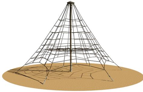
Certificata in conformità delle Norme Europee EN 1176 dall'Istituto TÜV-RHEILAND. Costituita da un montante principale in acciaio zincato a caldo, assemblato ad una rete piramidale mediante connettori in alluminio. La rete piramidale è composta da fune armata Ø16mm. Sistema di ancoraggio: da interrare.
