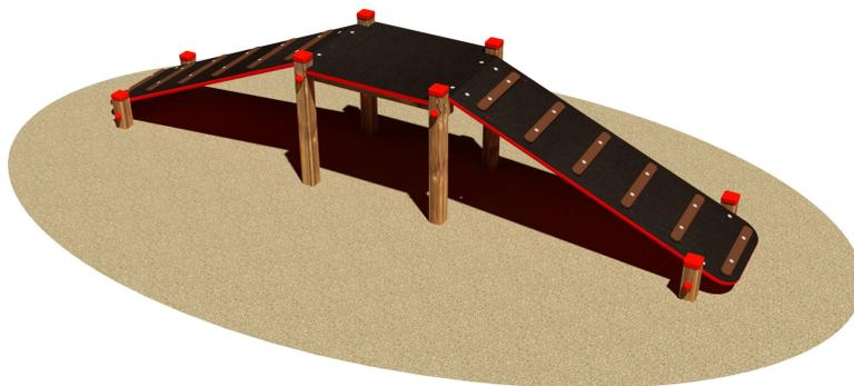
Realizzato in legno di pino nordico impregnato in autoclave con sali atossici. Costituita da n° 1 pedana orizzontale e n° 2 pedane inclinate in multistrato di betulla ad incollaggio fenolico, con zigrinatura antiscivolo, e rifinitura con film colorati in entrambi i lati, sorrette da n° 4 montanti in legno di pino lamellare della sez. cm 7x7. Assemblaggio mediante bulloneria in acciaio zincato 8.8 e dadi autobloccanti. Elementi copridado a norma in nylon colorato. Tappi copripalo in polietilene.
