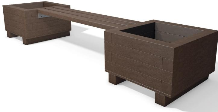
Fioriera interamente in plastica riciclata al 100% hanit® composta da N.1 seduta da 150 x 35cm realizzata con n. 3 profili di sezione rettangolare da 4,5 x 10,5 cm di cui n.2 rinforzati N.2 fioriere quadrate 69 x 69 cm realizzate con profili di sezione rettangolare da 6 x 12 cm Il fondo è realizzato con piastra di spessore 2,5 cm e provvisto di piedi per una eventuale facile movimentazione
