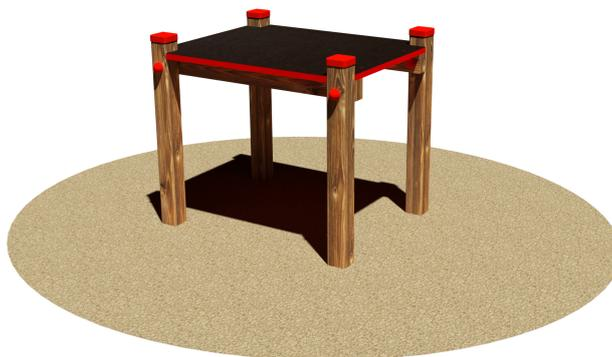
Realizzato in legno di pino nordico impregnato in autoclave con sali atossici. Costituita da n° 1 pedana in multistrato di betulla ad incollaggio fenolico, con zigrinatura antiscivolo, e rifinitura con film colorati in entrambi i lati. Posizionata ad altezza di cm 65 mediante n° 4 montanti in legno di pino lamellare della sez. cm 7 x 7. Assemblaggio mediante bulloneria in acciaio zincato 8.8 e dadi autobloccanti. Elementi copridado a norma in nylon colorato. Tappi copripalo in polietilene.
