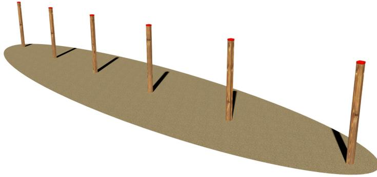
Realizzato in legno lamellare di pino nordico impregnato in autoclave con sali atossici. Costituita da n° 6 montanti verticali posizionati consecutivamente a idonea distanza. Assemblaggio mediante bulloneria in acciaio zincato 8.8 e dadi autobloccanti. Elementi copridado a norma in nylon colorato. Tappi copripalo in polietilene. Ingombro max: cm 950 x 7 x 120 h
