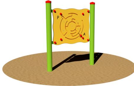
Pannello sensoriale per parco giochi inclusivi. Conforme alla Norma Europea EN 1176. Realizzato con struttura portante in tubolari tondi di acciaio elettrozincato e verniciato aventi la sez.  $\varnothing$  89 mm, collegati ad un pannello labirinto in bilaminato stratificato HPL pantografato e privo di spigoli. Verniciatura a forno a 180° C. Assemblaggio con bulloneria in acciaio zincato 8.8 e dadi autobloccanti. Elementi copripalo e copripalo a norma in nylon colorato.
