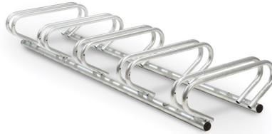
Porta bici da pavimento. A cinque posti, interamente zincato a caldo. Realizzato con struttura portante in tubo di acciaio Ø 40 mm, elementi di parcheggio biciclette in tubo tondo di acciaio Ø 25 mm. Munito di piastre per ancoraggio nel terreno.
