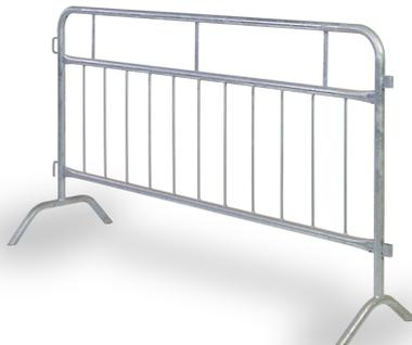
Zincatura a caldo. Struttura in tubo tondo di acciaio da Ø mm. 35, sbarre verticali in tondo pieno da Ø mm. 10 saldate alla distanza di cm. 12. Aggancio rapido con due ganci e due graffe laterali. Spazio orizzontale predisposto per l'inserimento di fasce (optionals) con pellicole bianco/rosso rifrangenti a norma marcato. Art.131 Transenna Roma da cm 200x110h - Peso kg 19 Art.137 Transenna Roma da cm 250x110h - Peso kg 23
