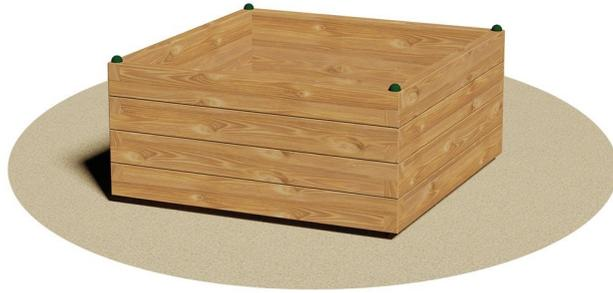
Fioriera in legno arredo parchi pubblici Modula. Realizzata interamente con fasce in legno di pino nordico impregnato in autoclave della sez. cm 11 x 4,5 e base in multistrato di betulla ad incollaggio fenolico con film colorati in entrambi i lati dello spessore di cm 1,9. Il tutto assemblato con bulloneria in acciaio zincata. La fioriera viene fornita al Cliente in kit di montaggio. Ingombro max: cm 100x100x50 h
