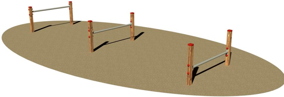
Realizzato in legno lamellare di pino nordico impregnato in autoclave con sali atossici. Composto da n° 3 moduli ostacolo, ogni modulo è costituito da n° 2 montanti della sez. cm 7x7, assemblati a n° 1 barra orizzontali realizzata con tubo tondo di acciaio zincato a caldo della sez. Ø 4 cm. Assemblaggio mediante bulloneria in acciaio zincato 8.8 e dadi autobloccanti. Elementi copridado a norma in nylon colorato. Tappi copripalo in polietilene.
