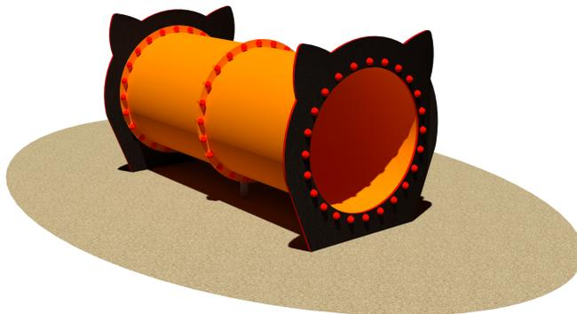
Realizzato con n° 2 elementi circolari cilindrici in vetroresina lavorata con vari strati di resina ad alta densità e n° 2 pannelli decorativi, di ingresso e uscita, realizzati in multistrato di betulla ad incollaggio fenolico, con zigrinatura antiscivolo, e rifinitura con film colorati in entrambi i lati. Assemblaggio mediante bulloneria in acciaio zincato 8.8 e dadi autobloccanti. Elementi copridado a norma in nylon colorato.
