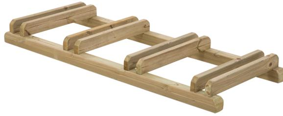
Struttura in legno di pino nordico impregnato in autoclave con sali atossici. Composto da N° 8 tavole sez. mm 35 x 80 accoppiate per formare 4 porta-ruota. N° 2 traverse sez. mm 70 x 70 in appoggio al suolo. Assemblaggio mediante viteria in acciaio zincato.
