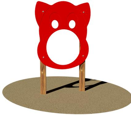
Realizzato in legno di pino nordico impregnato in autoclave con sali atossici. Costituita da n° 2 montanti in legno di pino lamellare della sez. cm 7 x 7 assemblati a n° 1 pannello in polietilene PEHD colorato pantografato e privo di spigoli dello spessore di mm 15. Assemblaggio mediante bulloneria in acciaio zincato 8.8 e dadi autobloccanti. Elementi copridado a norma in nylon colorato. Tappi copripalo in polietilene. Ingombro max: cm 80 x 9 x 128 h
