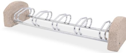
Portabici rastrelliera da terra. Realizzato con supporti in cemento armato vibrato. Telaio centrale in tubo di acciaio Ø 40 mm con elementi di parcheggio biciclette in tubo tondo di acciaio Ø 25 mm. Interamente zincato a caldo. Assemblaggio con bulloneria in acciaio zincato 8.8.
