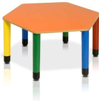
Piano di scrittura in agglomerato di particelle fibrolegnose ricoperto su ambedue le superfici in laminato plastico melaminico con finitura antigraffio nello spessore complessivo di mm 18 Bordatura perimetrale in ABS a sezione arrotondata a norma antinfortunistica con eliminazione degli spigoli 6 gambe in polipropilene colorato da mm 60 Dim 6 lati da 63x52H. Colori disponibili: Arancio,Blu,Giallo, Rosso e Magnolia
